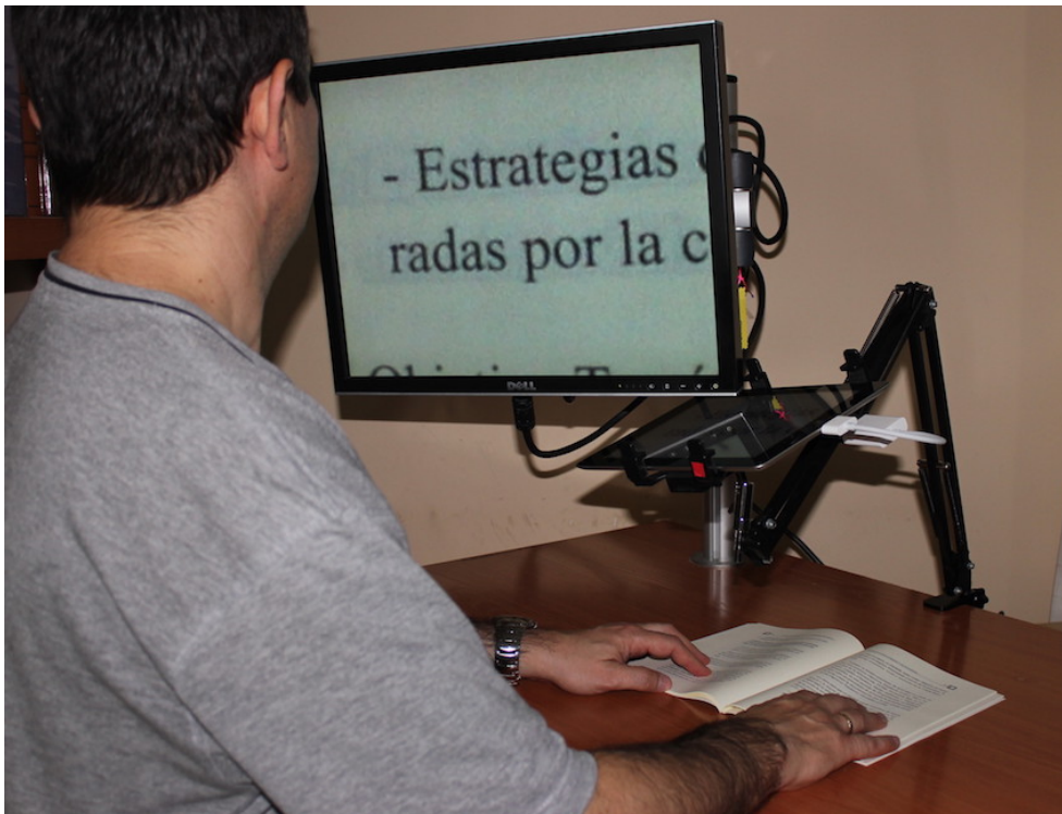
Aplicación de una telelupa de bajo costo
